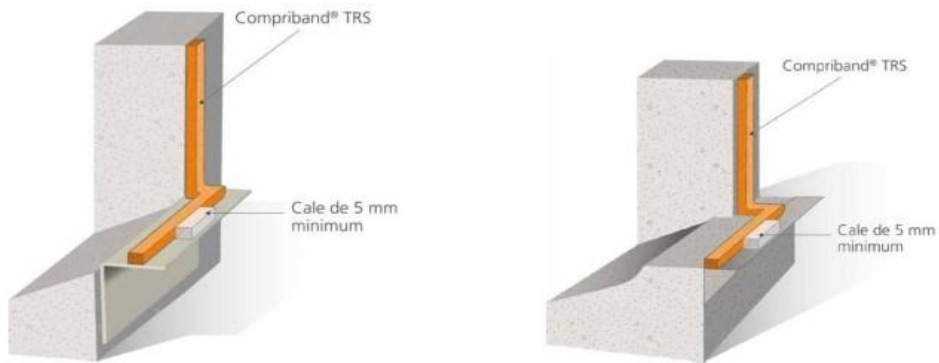
Croquis : Pose sous appui de fenêtre
