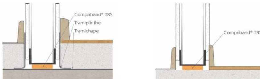
Croquis : Etanchéité sous cloison séparative
